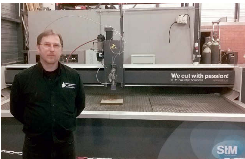
Edwin De Vlieger: “Deze waterstraalsnijmachine gebruikt een hogedrukpomp van 3.800 bar (37 kW) en is uitgerust met een snijkop die onder hoek gezet kan worden tot \pm 45^\circ ”
